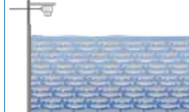
Medición de nivel en tanques de piscicultura.
